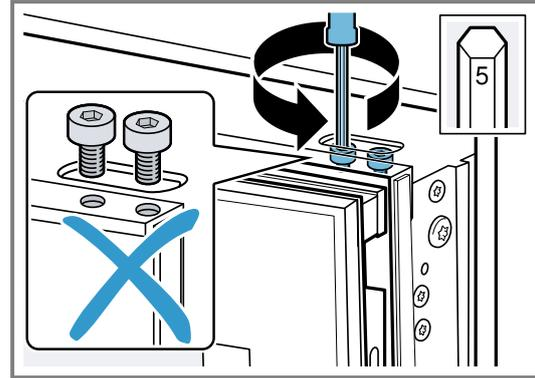
4. Die Gerätetür mit der seitlichen Schraube justieren, dazu bei Bedarf die Gerätetür öffnen und wieder schließen.
