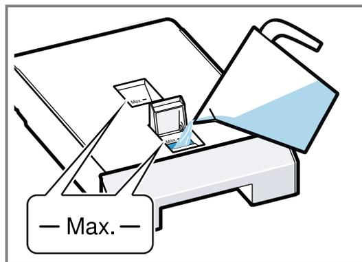
10. Den Frischwassertank vollständig bis zum Anschlag einschieben.
