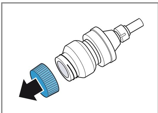
10. Die Reinigungskartusche **a** in die Buchse oben im Garraum bis zum Anschlag einschrauben.
