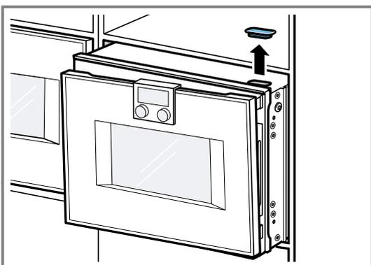
3. Die beiden Schrauben etwas lösen, aber nicht vollständig herausdrehen.
