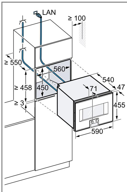
Beim Einbau von 2 Geräten nebeneinander beide Griffmulden zur Mitte ausrichten.
