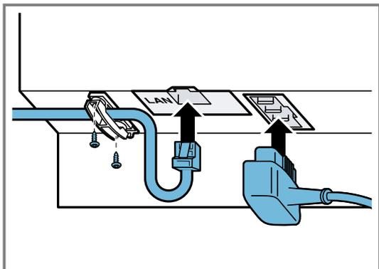
3. Das LAN-Kabel mit einem Netzwerkanschluss verbinden.
