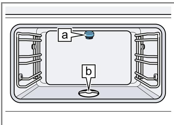
Die Reinigungskartuschen erhalten Sie beim Kundendienst oder im Online-Shop. Die Reinigungskartuschen können Sie nur einmal verwenden und nicht nachfüllen. Verwenden Sie keinen anderen Reiniger. Das komplette Reinigungsprogramm dauert ca. 4 Stunden 20 Minuten. Das Reinigungsprogramm läuft automatisch ab. Nach ca. 3 Stunden 40 Minuten entleeren
