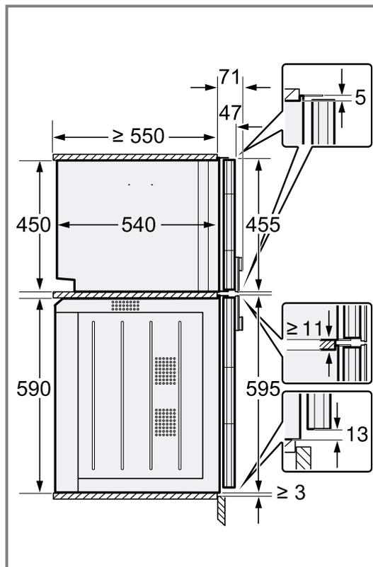
3. Wenn sich kein Zwischenboden über dem Gerät befindet, das Gerät im Schrank gegen Kippen sichern. 2 handelsübliche Winkel beidseitig im Schrank auf 450 mm Tiefe, 5 mm über der Gerätehöhe befestigen.
