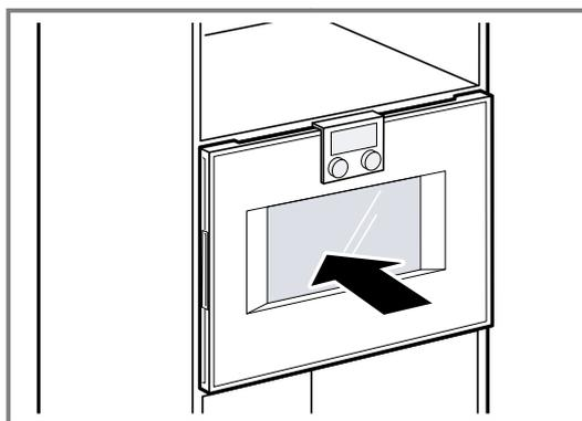
5. Das Gerät mittig ausrichten. Zwischen dem Gerät und den angrenzenden Möbelfronten ist ein Luftspalt von 5 mm erforderlich.
