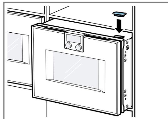
8. Insérez l'appareil dans la niche d'encastrement.
