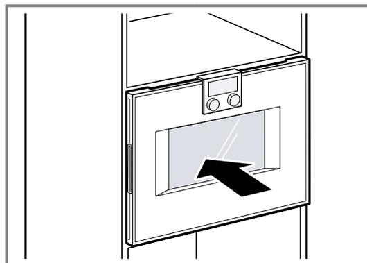
5. Centrez l'appareil. Une fente d'aération de 5 mm est nécessaire entre l'appareil et la façade des meubles voisins.
