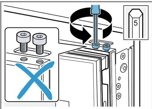
4. Réglez la porte de l'appareil à l'aide de la vis latérale, en ouvrant et en fermant la porte de l'appareil si nécessaire.
