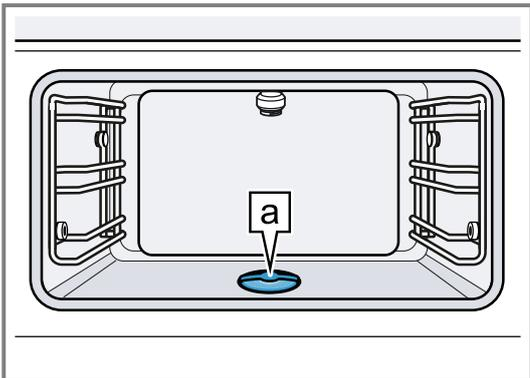
Si vous retirez le filtre à tamis (a) avant le programme de nettoyage, le compartiment de cuisson ne sera pas propre.
