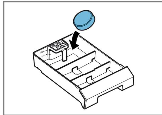
8. Poser le couvercle sur le réservoir d'eau fraîche et l'encliquer.
