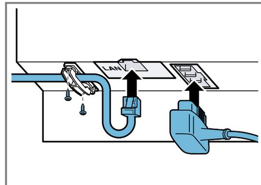
3. Connectez le câble LAN à une connexion au réseau.
