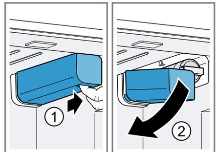
2. Den Wasserfilter nach links unten klappen ①, um 90° gegen den
