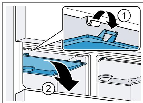
**Montaggio della copertura del contenitore a 0 °C**
