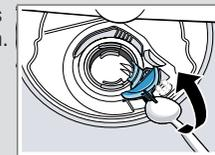
5. Die Pumpenabdeckung schräg nach innen anheben und entnehmen.
