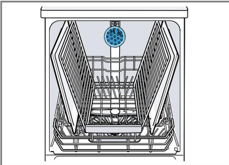
Damit der Sprühstrahl alle Teile erreichen kann, ordnen Sie maximal 2 Backbleche und 2 Gitter wie abgebildet ein.
