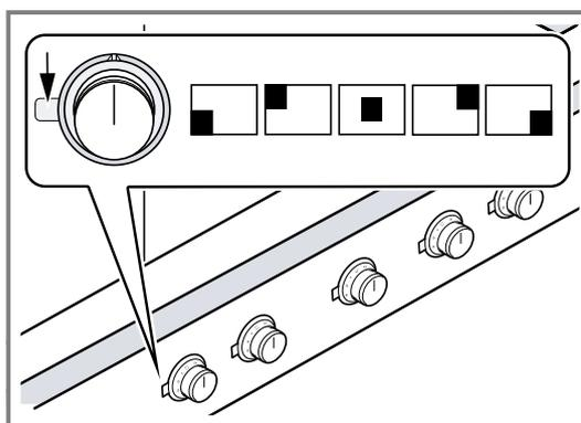
6. Den Bedienknopf in die Bohrung stecken.
