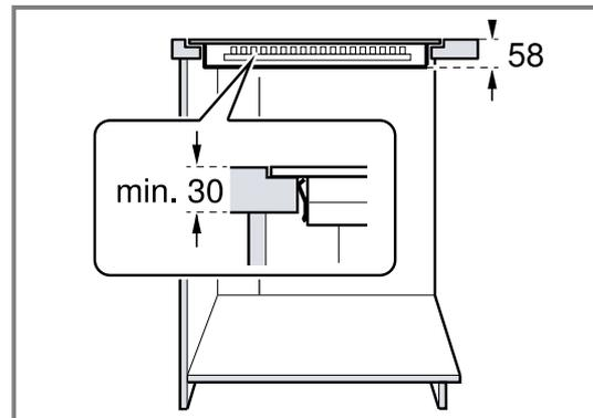
3. Den Mindestabstand von der Oberkante der Arbeitsplatte zu der Oberkante einer darunter eingebauten Schublade einhalten.
