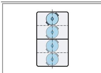
Bei einem Durchmesser bis 13 cm das Kochgeschirr in einer der vier Positionen gemäß Abbildung positionieren.
