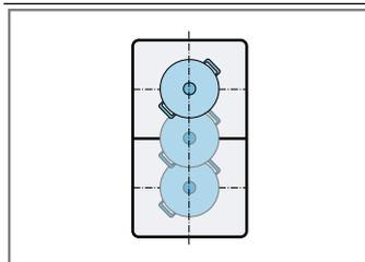
Bei einem Durchmesser über 13 cm das Kochgeschirr in einer der drei Positionen gemäß Abbildung positionieren.
