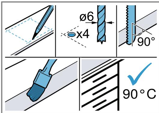
6. Staub und Rückstände der Ausschneearbeiten entfernen. Die Schnittflächen hitzebeständig und wasserdicht versiegeln.
