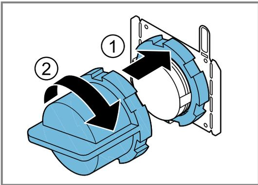
9. Den Bedienknebel exakt in Nullstellung ausrichten.
