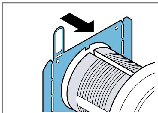
8. An der Rückseite des Bedienknebel die Haltemutter mit dem beiliegenden Montagewerkzeug festschrauben.
