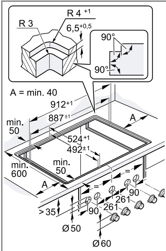
5. Sicherstellen, dass der Winkel der Schnittfläche zur Arbeitsplatte  $90^\circ$  beträgt.
