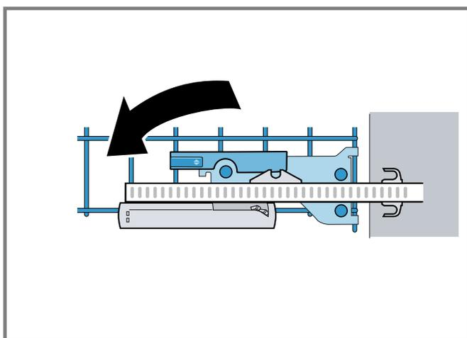
4. Pousser les rails de guidage dans l'appareil.
