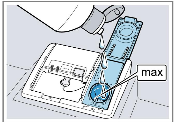
3. Si le réservoir déborde, retirez l'excédent de la cuve. Le liquide de rinçage excédentaire peut entraîner la formation excessive de mousse lors du rinçage.
