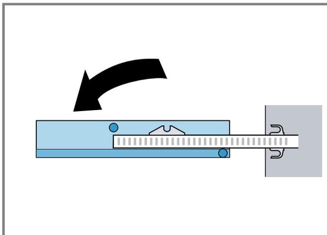
4. Pousser les rails de guidage dans l'appareil.
