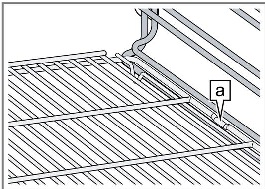
Les taquets d'arrêt se trouvent respectivement à gauche et à droite, à l'extérieur et au centre de la grille.
