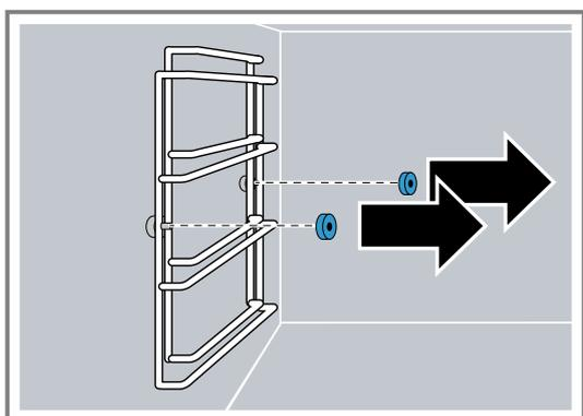
3. Tirez les grilles d'insertion légèrement sur le côté en les éloignant de la vis ①, puis extrayez-les vers l'avant ②.
