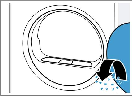
3. Das zweiteilige Flusensieb entfernen.
