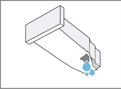
Prüfen Sie regelmäßig den Filter des Kondenswasserbehälters und reinigen Sie einen verunreinigten Filter. → Seite 45
