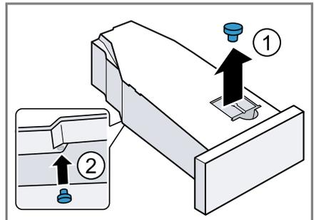
2. Den Filter im Kondenswasserbehälter reinigen.
