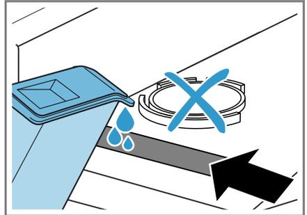
Prüfen Sie regelmäßig den Filter des Wassertanks und reinigen Sie einen verunreinigten Filter.
