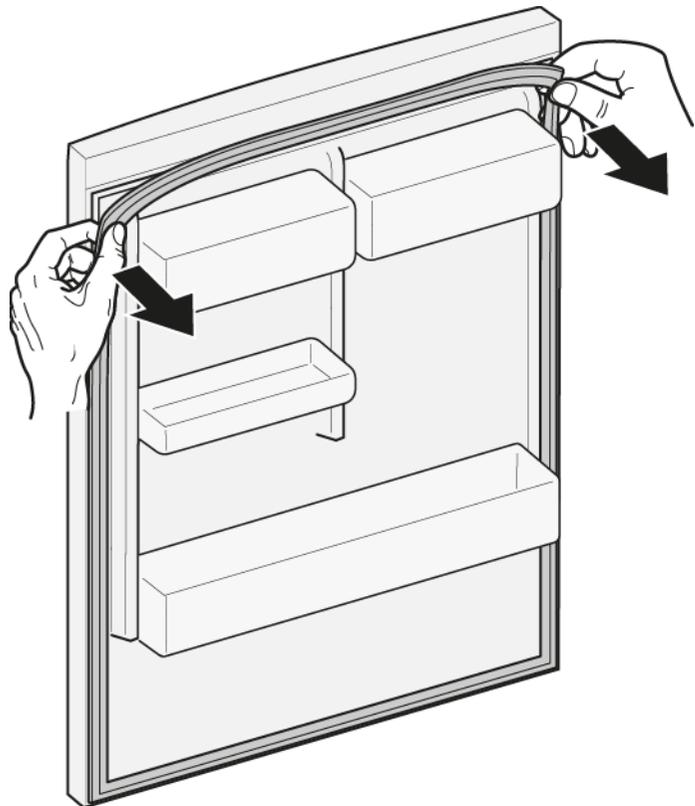
2. Demontați garnitura ușii din canelură.
