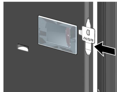
2. Tirer le cache du projecteur LED vers l'intérieur et le pousser simultanément vers l'avant.
