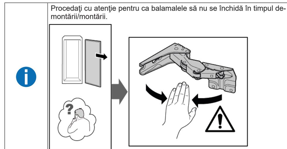
1. Demontați capacele a două balamale.
