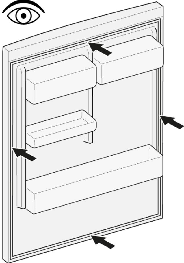
4. Presionar las esquinas de la junta en la parte superior y la inferior de la ranura.
