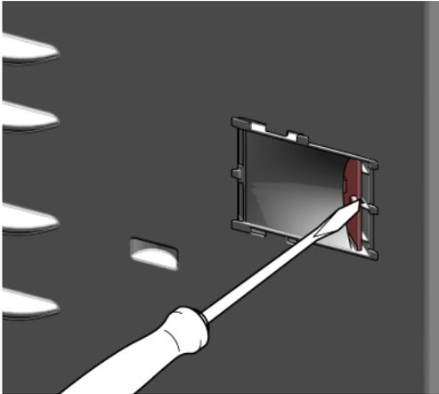
4. Odpojte elektrické pripojenie bodového LED svetla.
