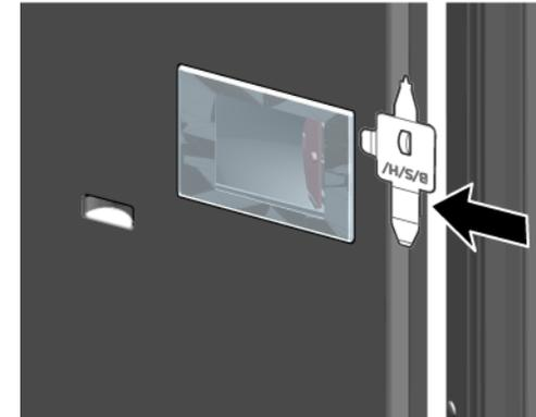
2. Die Abdeckung des LED-Strahlers nach innen ziehen und gleichzeitig nach vorn schieben.
