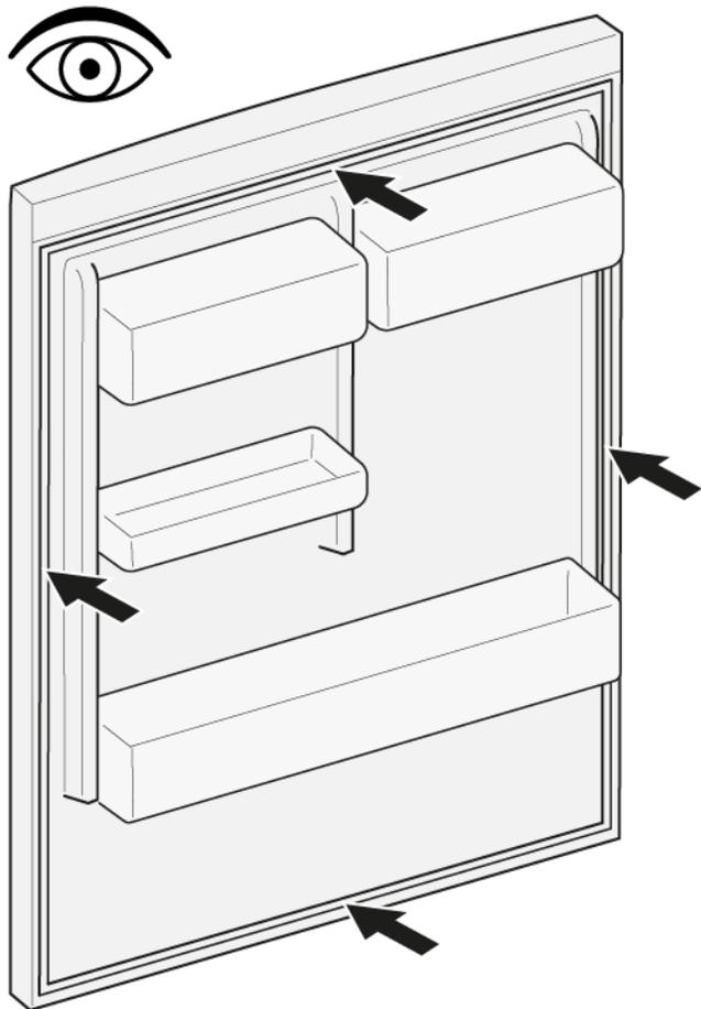
4. Zatlačte horní a dolní rohy těsnění do drážky.
