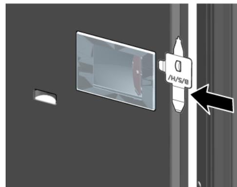
2. Potiahnite kryt bodového LED svetla dovnútra a zároveň zatlačte dopredu.
