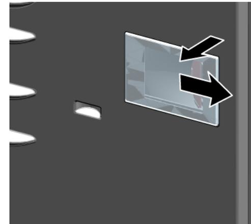
3. Das LED-Strahler-Modul lösen.
