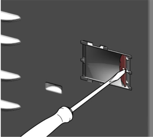
4. Desconectar la conexión eléctrica del foco LED.
