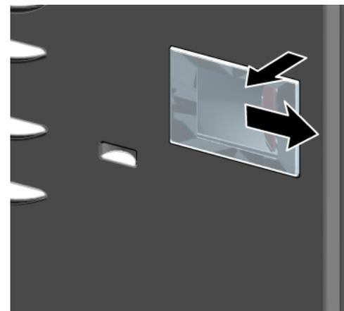
3. Odłączyć moduł oświetlenia punktowego LED.
