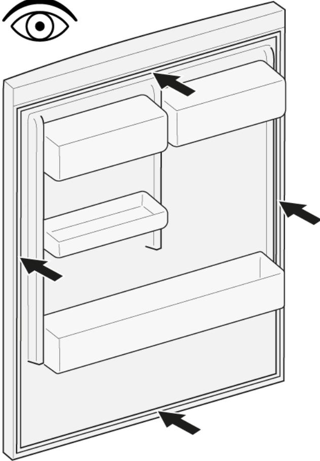
4. Die Dichtungsecken oben und unten in die Kerbe drücken.
