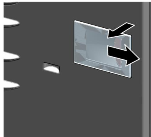
3. Odvojite modul LED usmjerenog svjetla.
