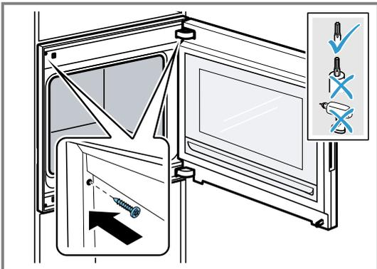
13. Die Transportsicherung an der Tür entfernen.
