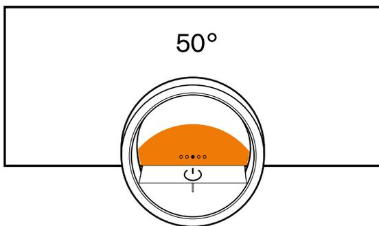
Der Ausschnitt des Kreises in Orange wird umso größer, je länger der Timer läuft oder je mehr sich die Kerntemperatur des Garguts der eingestellten Kerntemperatur nähert.
