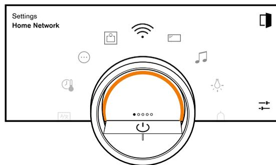
Während dem Betrieb des Geräts ist die Bedienung über den Bedienring nur möglich, wenn Sie zuvor eine Funktion auf dem Display wählen.
