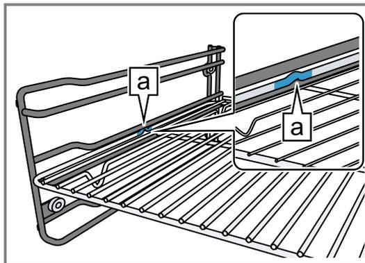
2. Sicherstellen, dass der Sicherheitsbügel des Rosts sich hinten befindet und nach oben zeigt.
