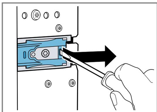
7. Wenn die Dicke der Möbelseitenteile 19 mm beträgt, die weißen Kunststoffeile entfernen ①, um 180° drehen ② und wieder einsetzen ③.
