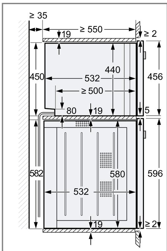
4. Wenn sich kein Zwischenboden über dem Gerät befindet, das Gerät im Schrank gegen Kippen sichern. 2 handelsübliche Winkel beidseitig im Schrank auf 450 mm Tiefe, 5 mm über der Gerätehöhe befestigen.
