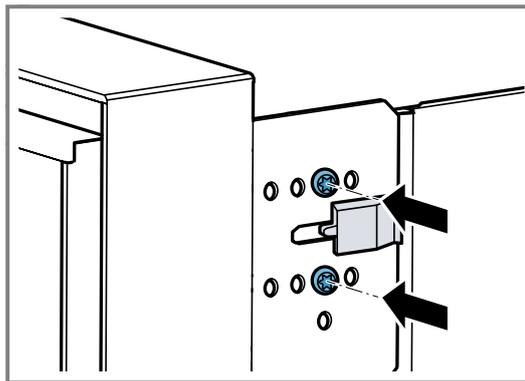
Je weiter rechts Sie die Schrauben am Gerät festschrauben, umso kleiner der Türöffnungswinkel. Bei der rechten Position der Schrauben beträgt der Öffnungswinkel der Gerätetür ca. 97°.
