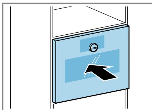
9. Das Gerät mittig ausrichten. Zwischen dem Gerät und den angrenzenden Möbelfronten ist ein Luftspalt von 5 mm erforderlich.
