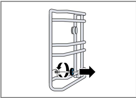
**3. Die Einschubroste etwas seitlich von der Schraube wegziehen ① und nach vorn herausziehen ②.**
