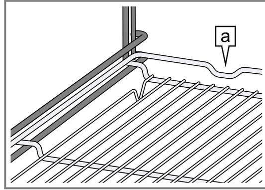
**Hinweis:** Zum vollständigen Entnehmen den Rost leicht anheben und mit beiden Händen herausziehen. Nehmen Sie das Zubehör aus dem Garraum, das Sie während des Betriebs nicht benötigen.
