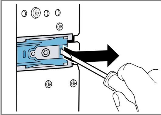
9. Wenn die Dicke der Möbelseitenteile 19 mm beträgt, die weißen Kunststoffeile entfernen ①, um 180° drehen ② und wieder einsetzen ③.
