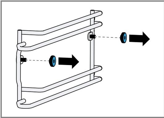
3. Die Einschubroste etwas seitlich von den Schrauben wegziehen ① und nach vorn herausziehen ②.
