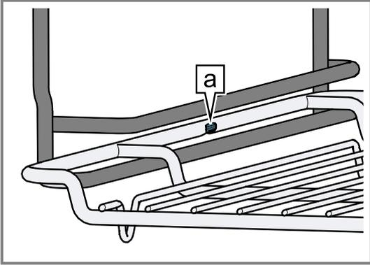
2. Sicherstellen, dass der Sicherheitsbügel des Rosts
