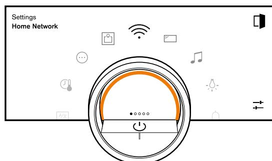
Durante l'esercizio dell'apparecchio, il funzionamento tramite l'anello di comando è possibile solo quando prima si seleziona una funzione sul display.
