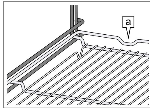
**Nota:** Per la rimozione completa, sollevare leggermente la griglia ed estrarla con entrambe le mani. Rimuovere dal vano cottura l'accessorio non necessario durante il funzionamento.
