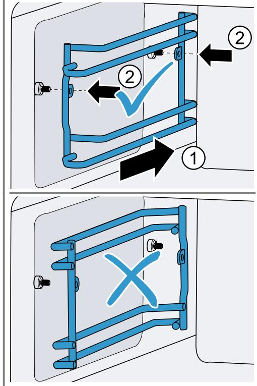
Le griglie a scorrimento per il alto sinistro e il alto destro del vano cottura sono diverse.
