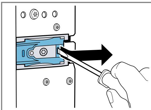
9. Se lo spessore della parte laterale del mobile è di 19 mm, rimuovere gli elementi di plastica bianchi ① per poterli ruotare di 180° ② e reinserirli ③.
