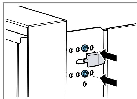
Je weiter rechts Sie die Schrauben am Gerät festschrauben, umso kleiner der Türöffnungswinkel. Bei der rechten Position der Schrauben beträgt der Öffnungswinkel der Gerätetur ca. 97°.
