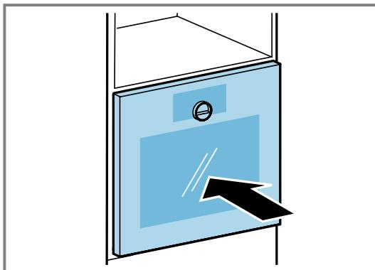
9. Das Gerät mittig ausrichten.
