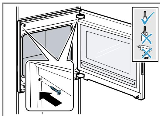
13. Die Transportsicherung an der Tür entfernen.
