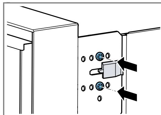
Più a destra vengono fissate le viti sull'apparecchio, più sarà ridotto l'angolo di apertura dello sportello. In caso di posizione corretta delle viti, l'angolo di apertura dello sportello dell'apparecchio è di ca. 97 .
