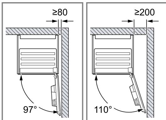
3. In caso di montaggio di due apparecchi sovrapposti, rispettare le distanze.
