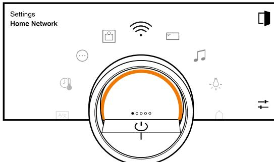
Durante l'esercizio dell'apparecchio, il funzionamento tramite l'anello di comando è possibile solo quando prima si seleziona una funzione sul display.
