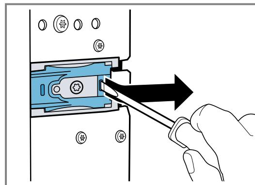
7. Se lo spessore della parte laterale del mobile è di 19 mm, rimuovere gli elementi di plastica bianchi ① per poterli ruotare di 180° ② e reinserirli ③.
