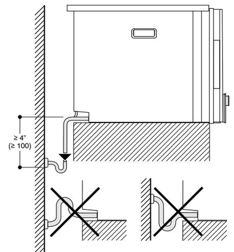
Ablaufschlauch an keiner Stelle höher als Geräteunterkante positionieren und mind. 100mm tiefer als Geräteanlauf.
