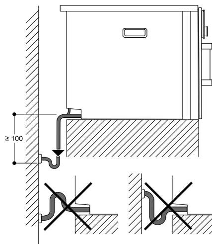
Ablaufschlauch an keiner Stelle höher als Geräteunterkante positionieren und mind. 100mm tiefer als Geräteanlauf.
