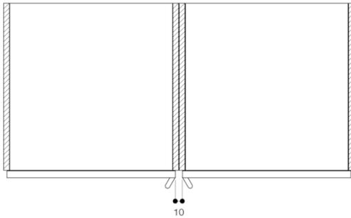
Luftquerschnitte an den Türkanten oben/unten
