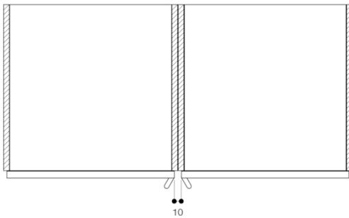
Luftquerschnitte an den Türkanten oben/unten
