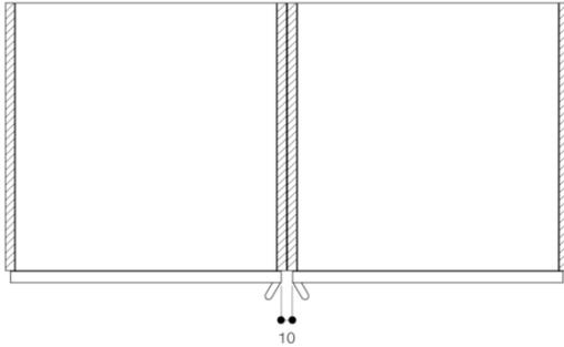
Luftquerschnitte an den Türkanten oben/unten
