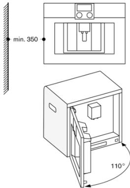
Bei Verwendung der 92° Scharnierbegrenzung (Ersatzteil Nr. 00636455), beträgt der Mindestabstand zur Wand nur 100 mm.
