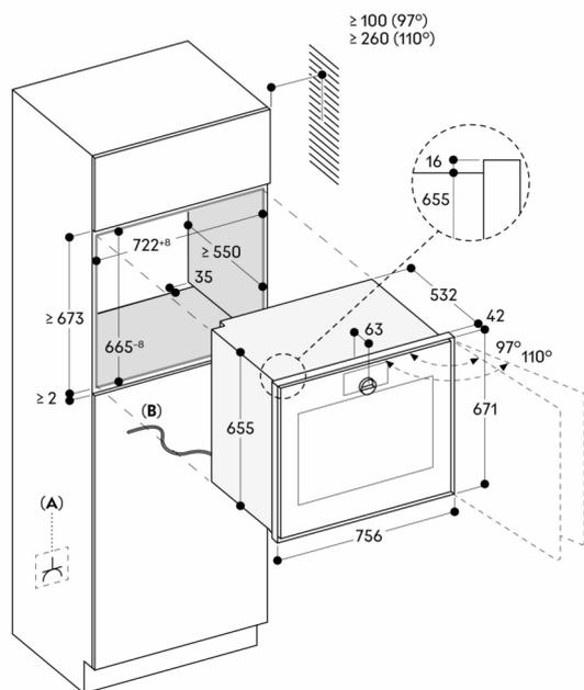
**A:** Frei zugänglicher elektrischer Anschluss
