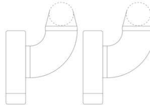
Anschluss VL an AR 413 mit Aluflexrohr NW 125
