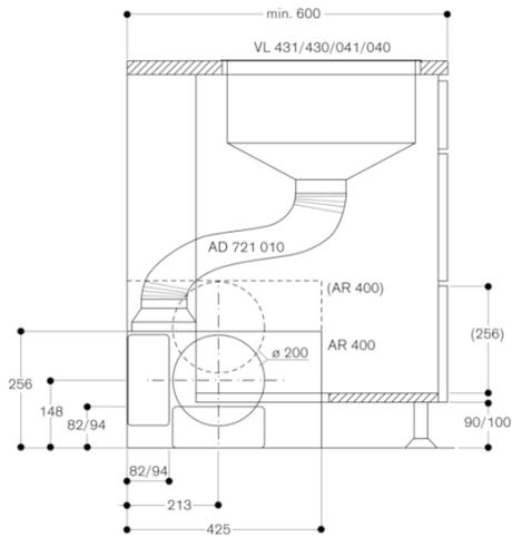
Anschluss VL an AR 400 mit Flachkanal NW 125/150
