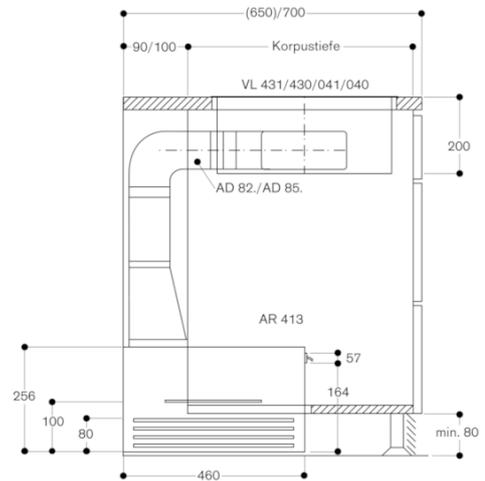
Anschluss VL an AR 413 mit Flachkanal+Aluflexrohr NW 150
