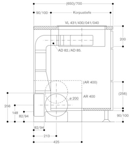
Anschluss VL an AR 400 mit Flachkanal+Aluflexrohr NW 150
