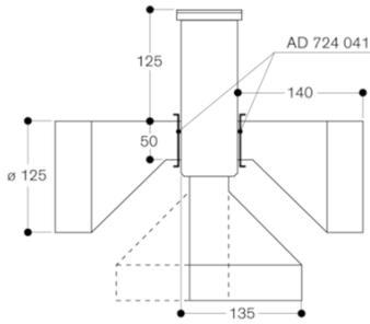
Anschluss VL an AR 400 mit Aluflexrohr NW 125
