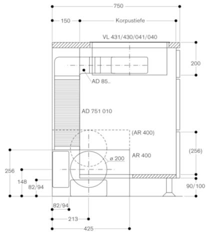
Anschluss VL an AR 413 mit Flachkanal NW 125/150
