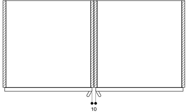
Luftquerschnitte an den Türkanten oben/unten
