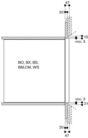
Luftquerschnitt an den Türkanten
