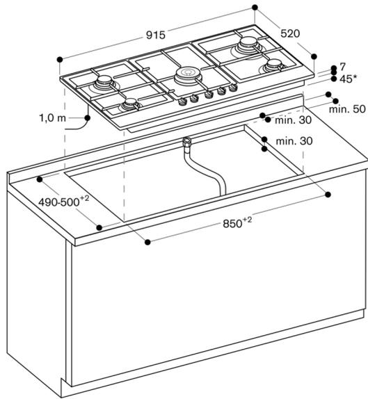
\* 61 mm im Bereich des Gasanschlusses hinten rechts
