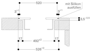
Bei Montage mit Geräteabdeckung oder Ausgleichsleiste, auf den tieferen Ausschnitt und die Nutbreite vorne und hinten achten.
