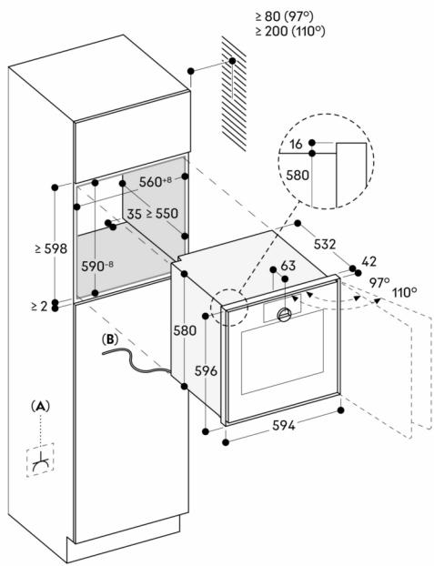
**A:** Frei zugänglicher elektrischer Anschluss
