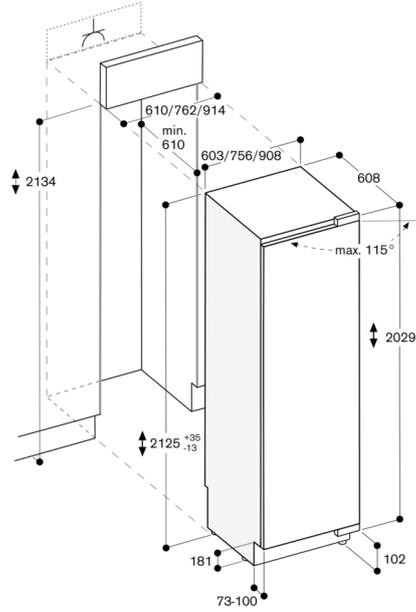
Die maximalen Türfrontmasse sind auf ein Spaltmass von 3 mm ausgelegt.
