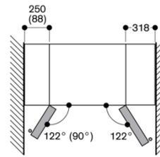
Bei Integration neben einer seitlichen Wand müssen links ein Abstand von 250 mm und rechts von 318 mm vorgesehen werden, damit Eisbereiter und Schubladen entnommen werden können.
