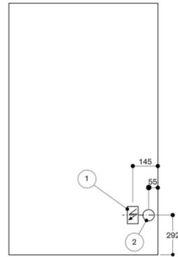
(1) Stromanschluss am Gerät
