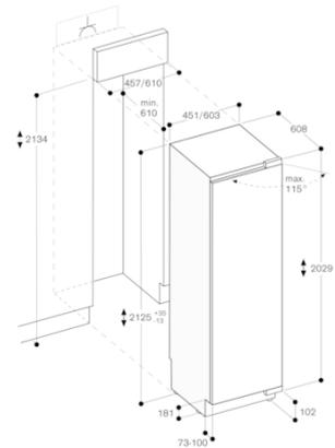
Die maximalen Türfrontmassen sind auf ein Spaltmaß von 3 mm ausgelegt.
