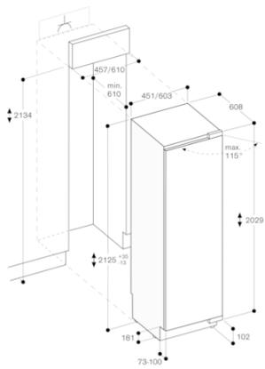
Die maximalen Türfrontmasse sind auf ein Spaltmaß von 3 mm ausgelegt.
