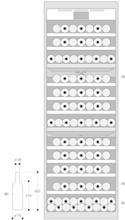
A: Geeigneter Bereich für die Aufbewahrung von Magnum-Flaschen bei der Ausführung mit Standardrückseite
