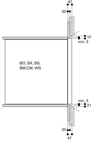
Luftquerschnitt an den Türkanten
