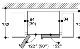
Bei Vollintegration müssen seitliche Abstände von 84 mm vorgesehen werden (bei 90° Türöffnung ist links ein Abstand von 39 mm zulässig). Bei 90° Türöffnung kann der Eisbereiter entnommen werden. Eine Entnahme der Schubladen ist bei einer Türöffnung von 122° möglich.
