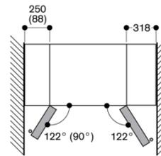
Bei Integration neben einer seitlichen Wand müssen links ein Abstand von 250 mm und rechts von 318 mm vorgesehen werden, damit Eisbereiter und Schubladen entnommen werden können.
