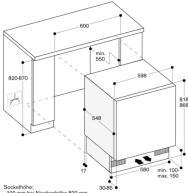
· 100 mm bei Nischenhöhe 820 mm · 150 mm bei Nischenhöhe 870 mm
