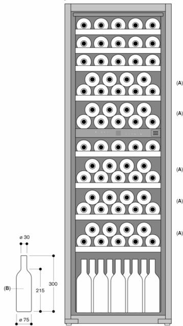
A: Geeigneter Bereich für die Aufbewahrung von Magnum-Flaschen bei der Ausführung mit Standardschublade
