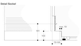
Bezogen auf die Standardhöhe des Gerätes beträgt die Höhe der Sockelleiste 102 mm. Maximale Dicke der Sockelleiste 19 mm.
