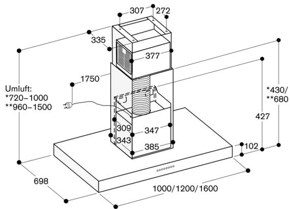
\* Mit dem Umluftkamin AD 442 116 für Deckenhöhen von 2,35 m bis 2,60 m geeignet.
