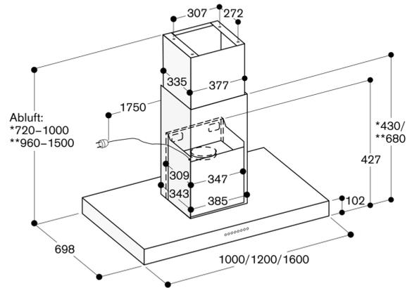
\* Mit dem Abluftkamin AD 442 016 für Deckenhöhen von 2,35 m bis 2,60 m geeignet.
