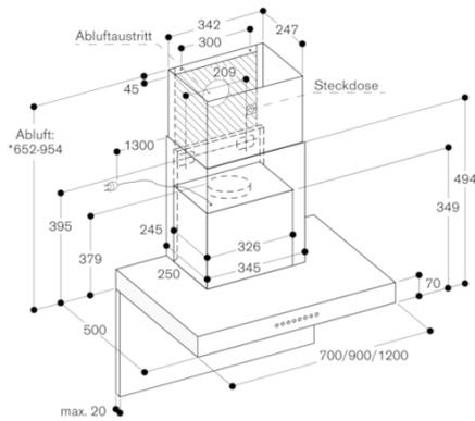
\*Für Deckenhöhen von 2,25 m bis 2,55 m geeignet;
