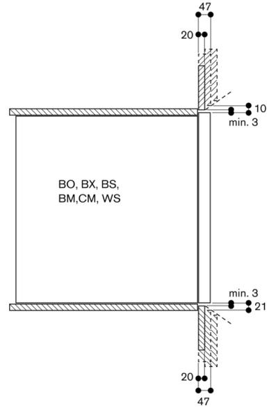
Luftquerschnitt an den Türkanten
