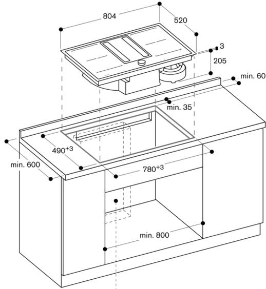
Bereich für das Umluftmodul oder den Kanal.
