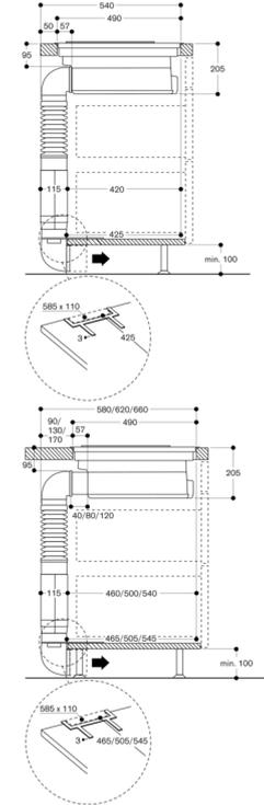
Vorderansicht CV 28. mit Flachkanal-Anschlussstutzen CA 284 011
