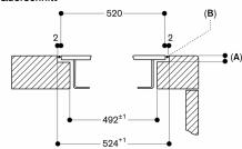
A: 3,5<sup>-0.5</sup> 6,5<sup>-0.5</sup>In Kombinationen mit rahmenlosen Induktionskochfeldern B: Füllung mit Silikon
