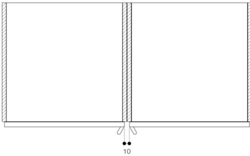
Secciones transversales de aire en los cantos superior e inferior de la puerta
