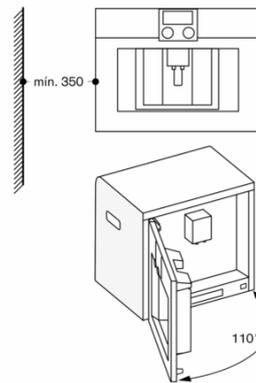
En caso de utilizar la limitación a 92° de la bisagra de la puerta (pieza de recambio n.º 00636455), la distancia mínima hasta la pared es de tan solo 100 mm.
