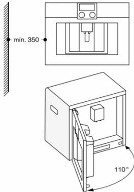
En caso de utilizar la limitación a 92° de la bisagra de la puerta (pieza de recambio n.º 00636455), la distancia mínima hasta la pared es de tan solo 100 mm.
