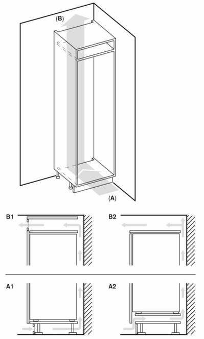
A: Abertura de entrada de aire  $\geq 200 \text{ cm}^2$ ; opciones de ventilación A1 o A2
