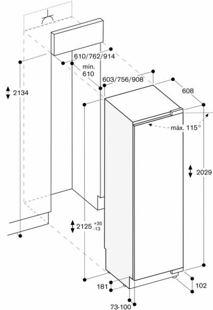
Las dimensiones máximas del frontal de la puerta están diseñadas para una holgura de 3 mm.
