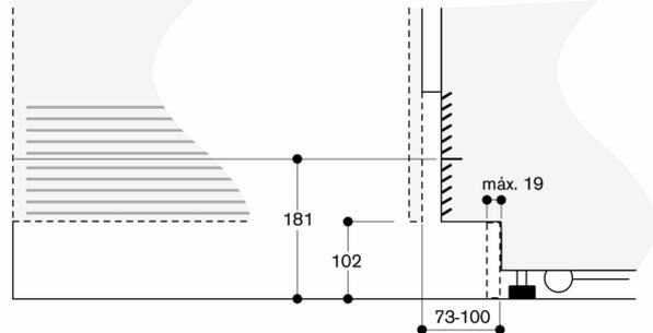
La altura estándar del aparato hace referencia a la altura del listón del zócalo de 102 mm. Grosor máximo del listón del zócalo 19 mm.
