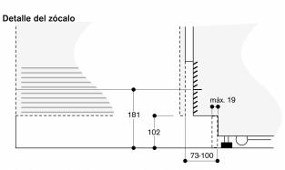
La altura estándar del aparato hace referencia a la altura del listón del zócalo de 102 mm. Grosor máximo del listón del zócalo 19 mm.
