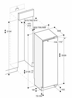
Las dimensiones máximas del frontal de la puerta están diseñadas para una holgura de 3 mm.
