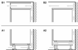
A: Abertura de entrada de aire  $\geq 200$  cm<sup>2</sup>; opciones de ventilación A1 o A2
