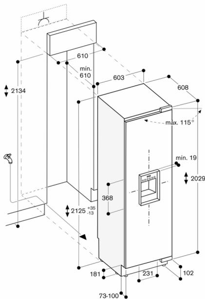
Las dimensiones máximas del frontal de la puerta están diseñadas para una holgura de 3 mm.
